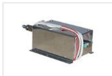
镍转化炉 (甲烷转化炉)
